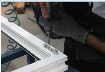
نصب صحیح لولای قابل تنظیم
