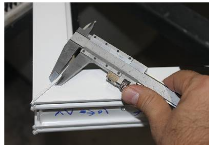
کنترل ضخامت تیغه جوش
