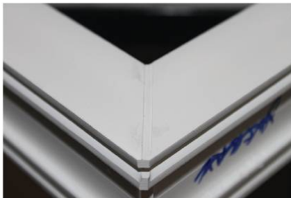
کنواختی عرض محل تمیز کاری پلیسه جوش
