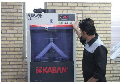
کنترل میزان استحکام جوش مقاطع
