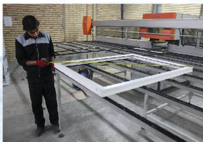
کنترل قطر چارچوب جوش داده شده
