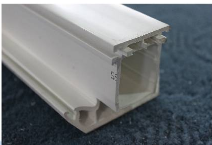
کنترل سطح مقطع پروفیل میانی فرزکاری شده
