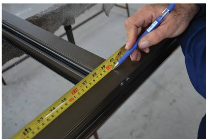
کنترل محل دقیق نصب پروفیل میانی
