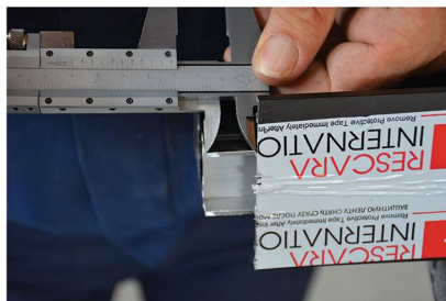
کنترل سطح مقطع پروفیل میانی
