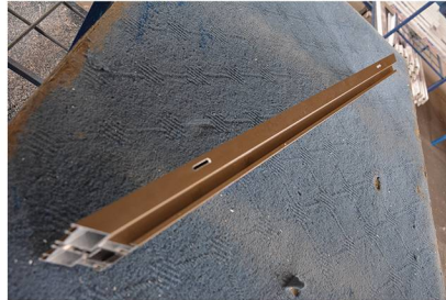
کنترل تعداد شیار آب
